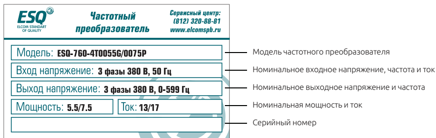
Рисунок 2-4. Изображение шильды частотного преобразователя ESQ-760
