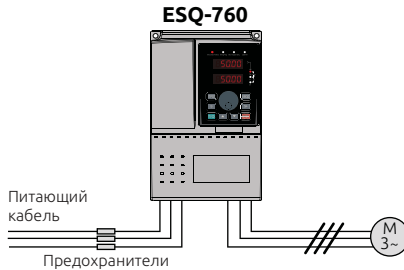
Рисунок 3-23. Схема установки предохранителей.
